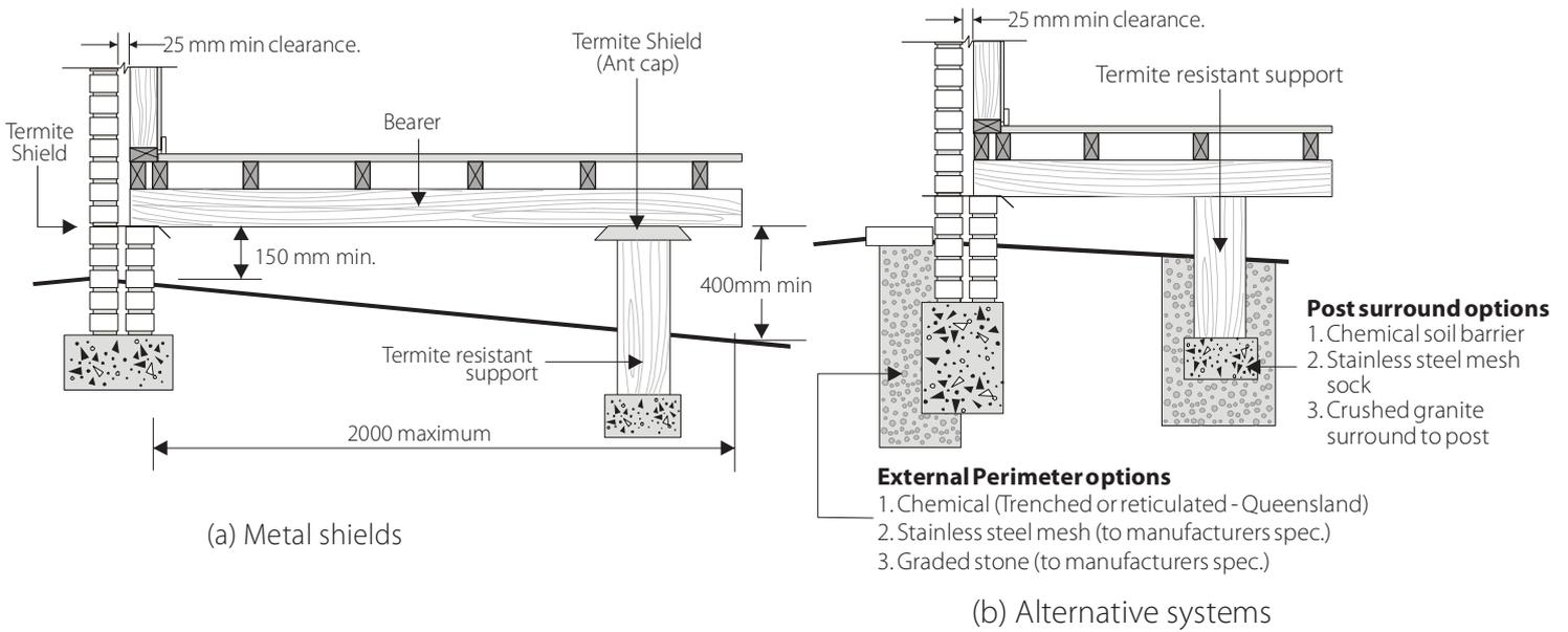
**FIGURE 3 TERMITE MANAGEMENT SYSTEMS FOR SUSPENDED TIMBER FLOORS**
